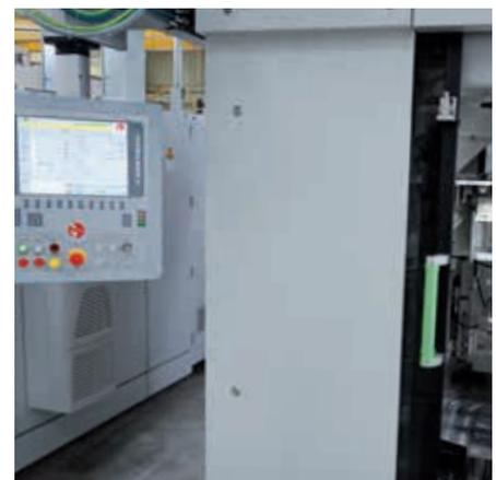
*Verfahrbares Bedienpult für Einblicke an jeder Station*
