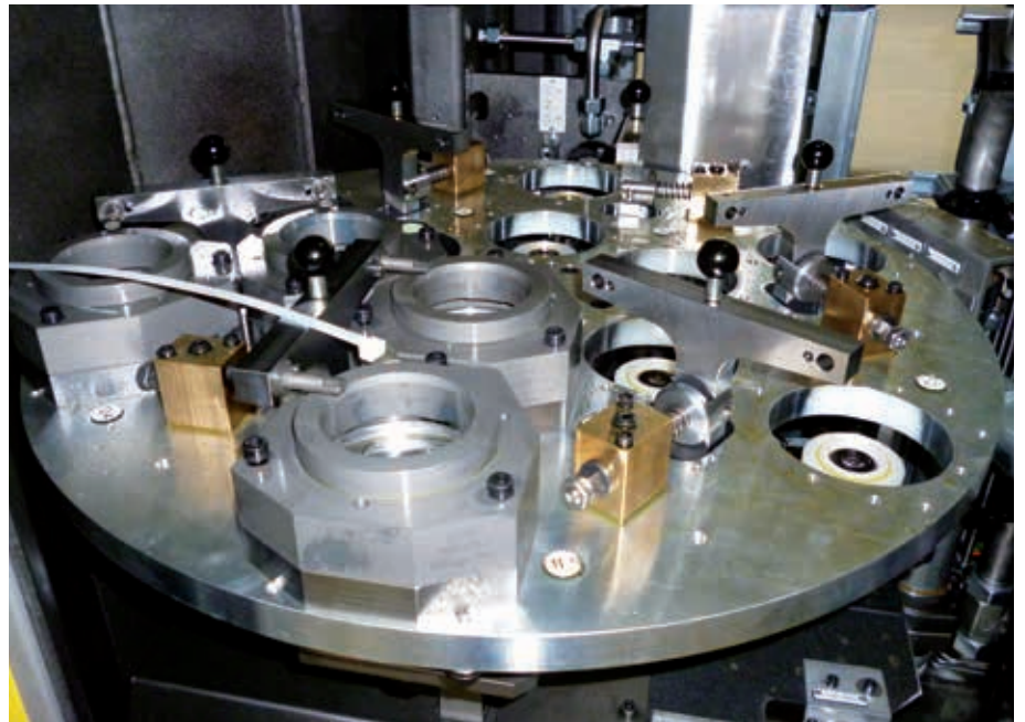
PT模块中的自动换刀数量可达12把刀具
