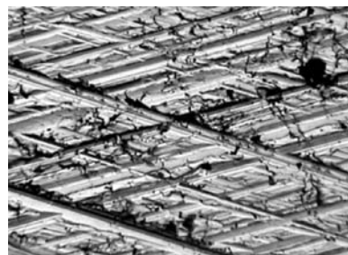
Bild 10: Fax-Bild, Oberfläche Diamant gehont mit keramischer Bindung (100 x)
