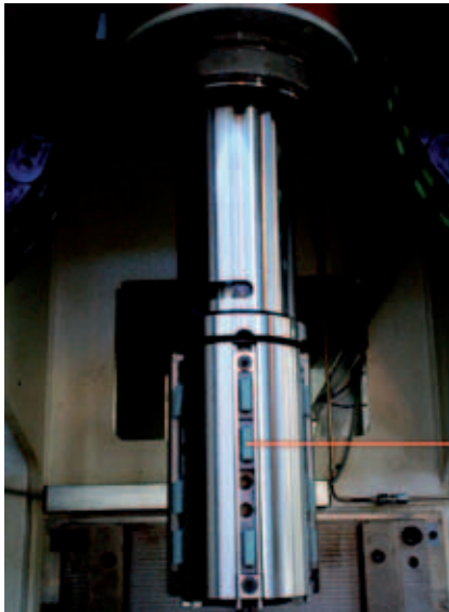
6 Glätthonwerkzeug mit elastisch gelagerten Honsegmenten
