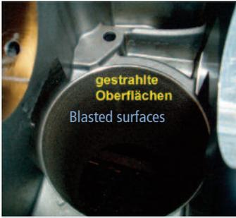
Bild 3: Wasserstrahlen und oversprayfreies gestrahltes Werkstück
