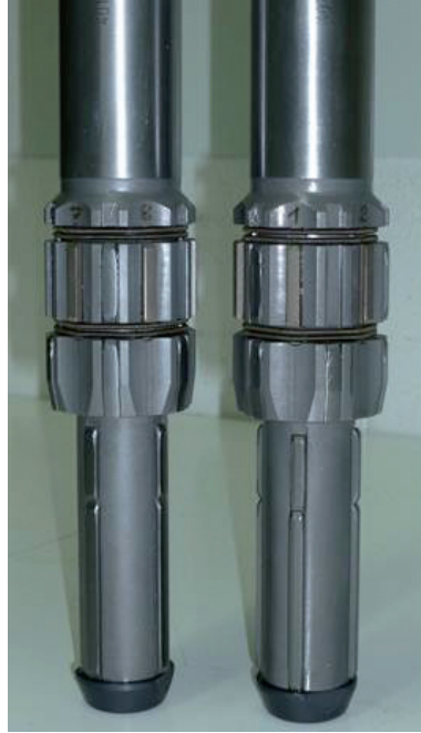
Abb. 4: Honwerkzeuge mit unterer Führung und cBN-Schneidkristalle (B213 / B46)
