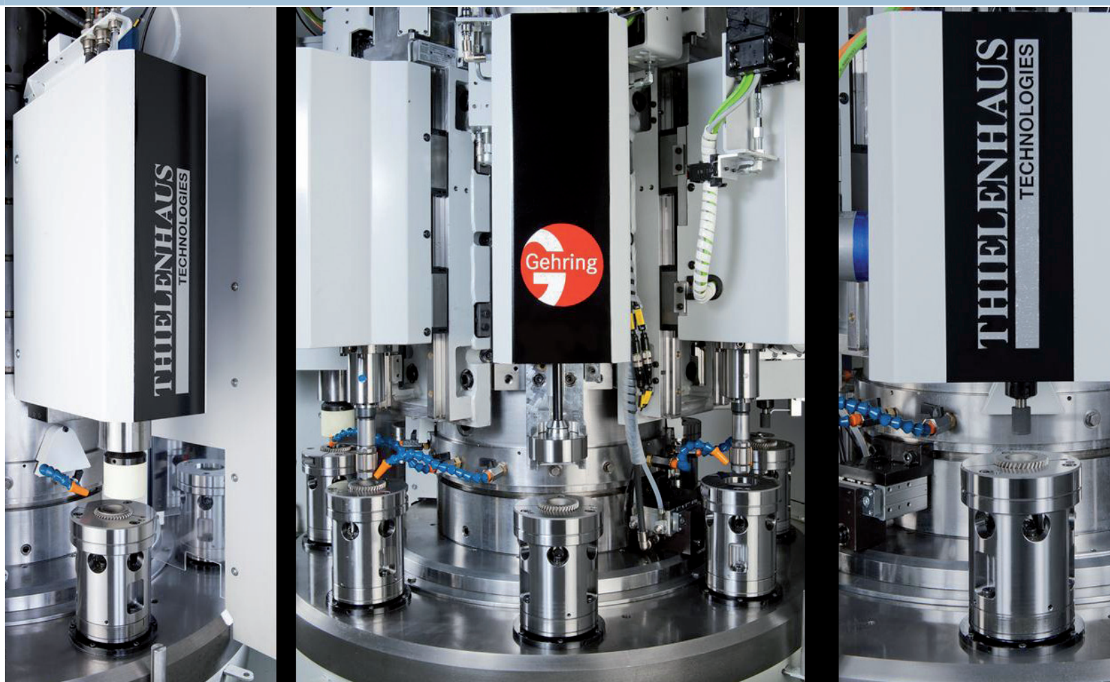
Abb. 8: Bearbeitungsstationen zum Bearbeiten von Planetenrädern
