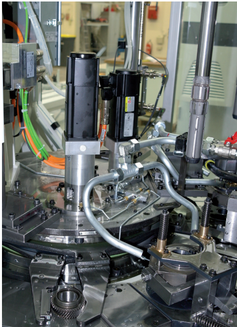
Abb. 2: Bearbeitungsstationen zum Honen von Schalträdern
