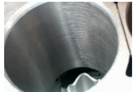
缸孔，左侧图片页：珩磨前的孔位置，右侧图片页：强力定位珩磨开始时的孔位置通过局部切割
