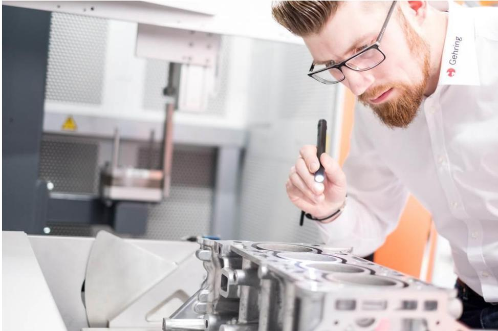
Bild 1: Das Nanohonon wird zur Herstellung von Motoren mit beschichteten Zylinderlaufbahnen eingesetzt, die dadurch kompakter und effizienter werden. Gearing liefert entsprechende Anlagen an Autobauer weltweit.
